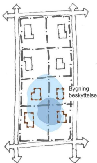
Figur 19: Bygninger kan beskyttes mod vand fra terræn med fx opkanter ved kældernedgange og -vinduer og ved ventilationsåbninger. Højvandslukker eller pumper kan sikre, at vandet ikke løber baglæns gennem kloakken og oversvømmer huset.
